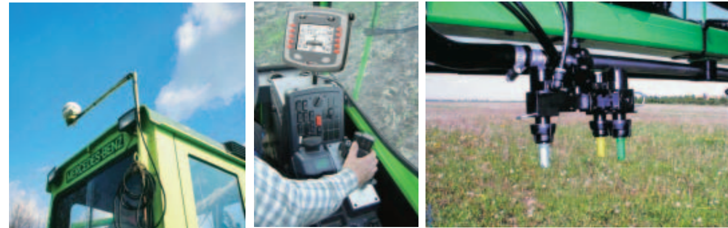
Abb. 4 bis 6: GPS-Antenne auf dem Traktor zur Positionsbestimmung. Mitte: ISOBUS-Terminal beim Fahrer als zentrales Steuerelement des Bordcomputers. Rechts: Mehrfach-Düsensträger am Spritzgestänge. Der Bordcomputer steuert situationsabhängig, mit welchem Düsentyp Pflanzenschutzmittel ausgebracht werden. So können in der Feldfläche beispielsweise Spritzmittel sparende Düsen mit feinsten Tröpfchenverteilung und an Feldrändern abdriftvermindernde Düsen aktiviert werden.
